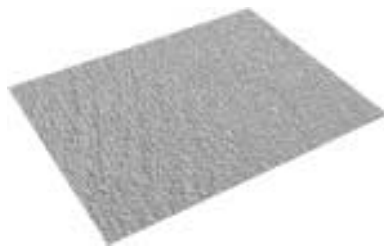
Рис. 6. Восстановленная топограмма поверхности меры отклонений от плоскостности диаметром 300 мм
